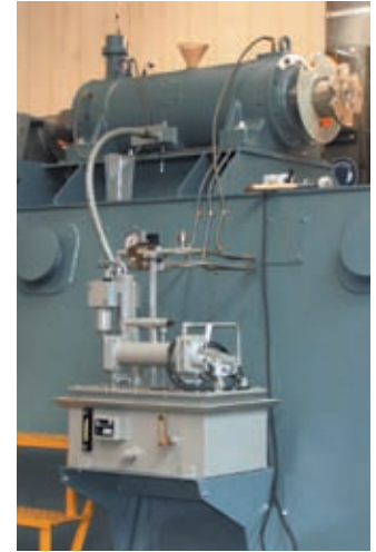
Montaggio di un ventilatore evaporatore da 1440 kW
