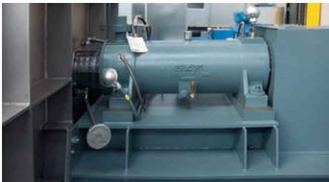
Cuscinetto a rotolamento con velo d'olio ammortizzante
