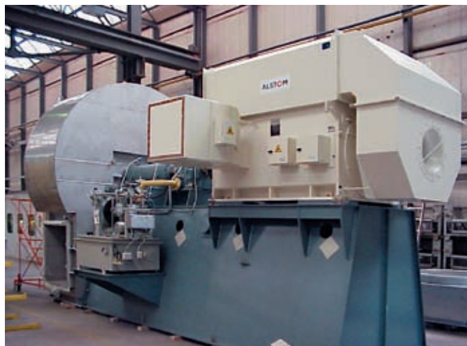
Compressore di vapore da 2600 kW per l'industria zuccheriera
