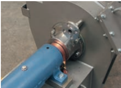
Sistema tenuta albero per Fines Removal Blower
